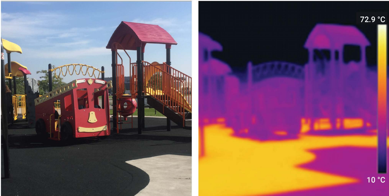
Figure 2.10 : Une image thermique du parc Captain John Wilson de Windsor (Ontario) montre que la température de la surface en caoutchouc foncé (zone jaune) sous la structure de jeu est de 69,0 °C. Les photos sont une gracieuseté de la Ville de Windsor.
